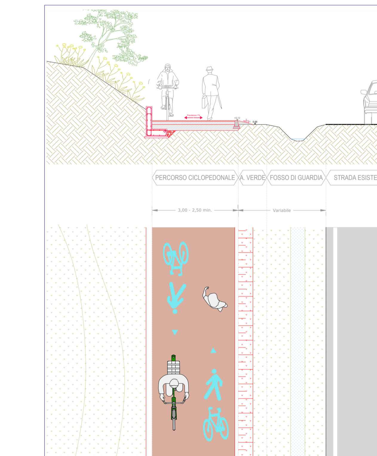
ST18 Sezione tipologica nuovo marciapiede ciclopedonale scala 1:100
