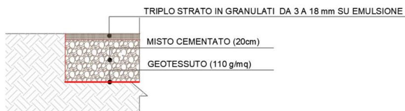
Stratigrafia costruttiva: triplo strato con granulato rullato.
