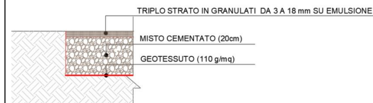
Stratigrafia costruttiva: triplo strato con granulato rullato.
