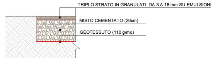
Stratigrafia costruttiva: triplo strato con granulato rullato.
