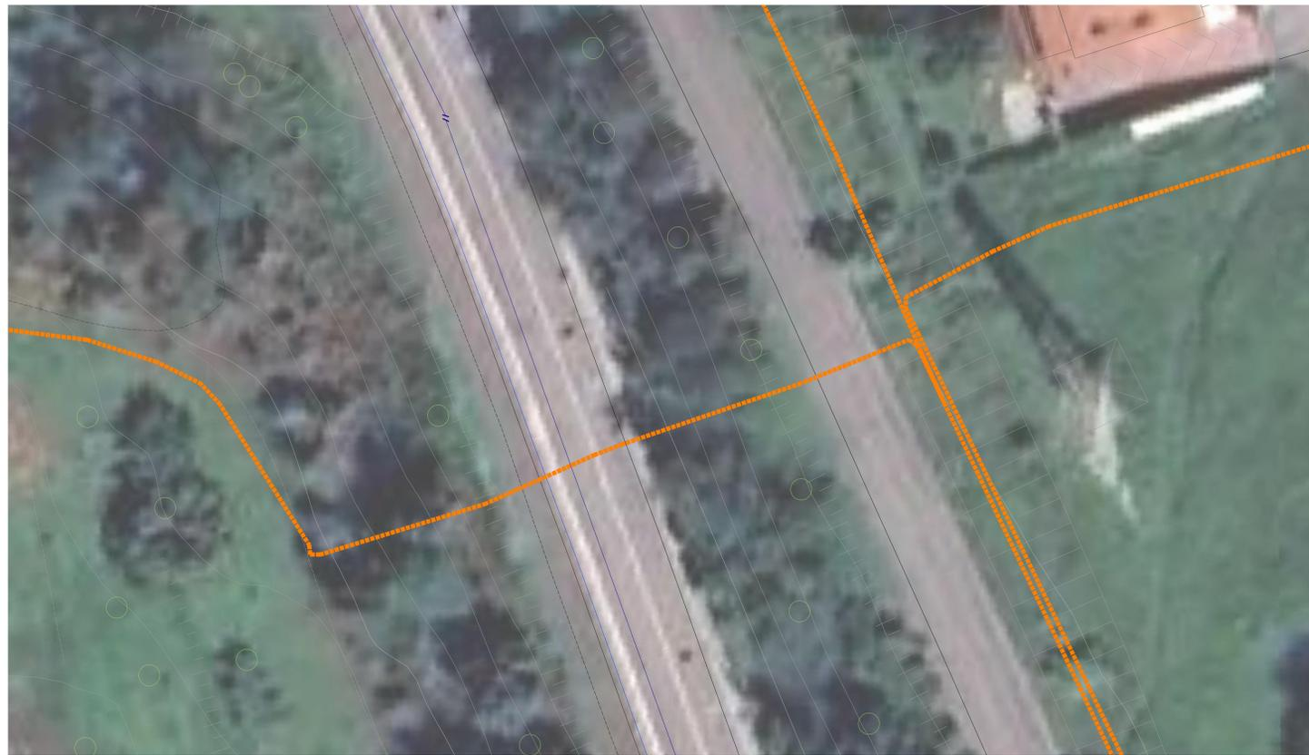
QUADRO CA-07 scala 1:200 TRACCIATO SNAM 4101157 Allacciamento Ecozinder DN 250 – 24 bar posato in protezione (cunicolo)
